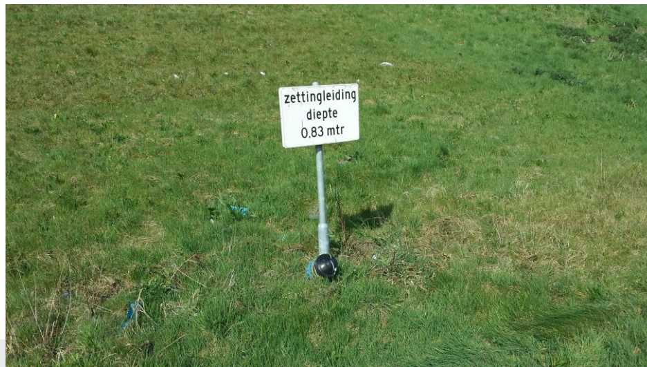
Foto: Duidelijk markering zettingsleiding.
