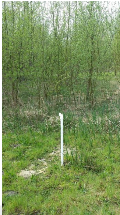
Foto: Monitoringsvoorziening kwetsbaar: peilbuis zonder mantelbuis.
